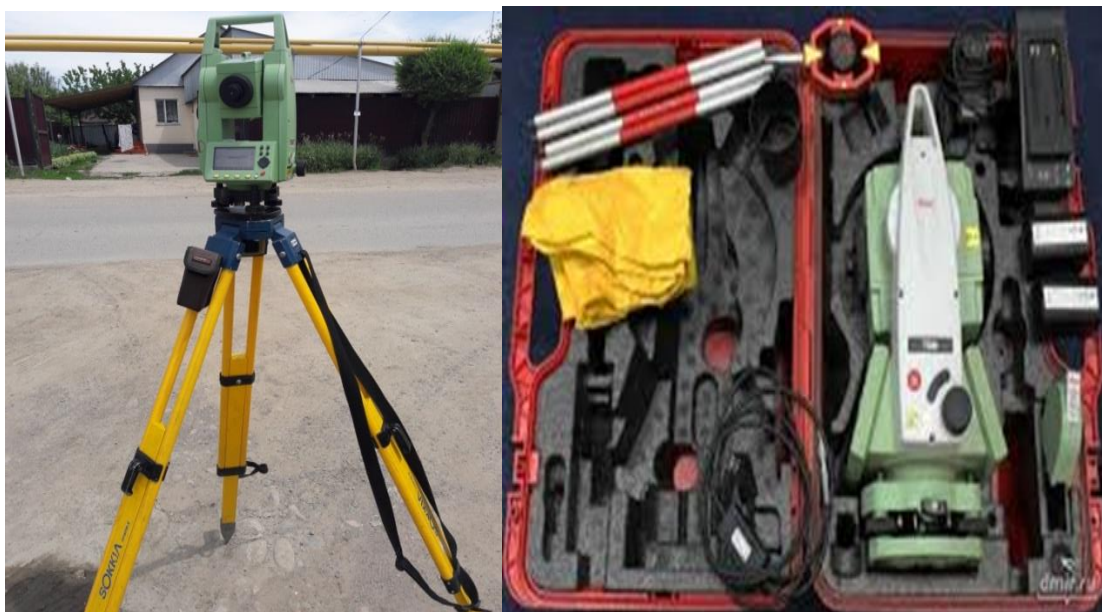
7 Сурет-LeicaTC407 электронды тахеометрі
